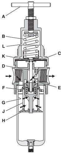
顺时针旋转T型手柄(A)向控制弹簧(B)施加压力,膜片(C)和阀芯组件(D)向下移动,使过滤后的空气通过阀芯组件和阀座之间的区域(E)。
